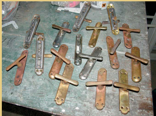
Fensterbeschläge: Links neue Fitschenbänder mit Kugelenden in Fensterfarbe, rechts wiederverwendete Fenstergetriebe mit Schild und Olive.
