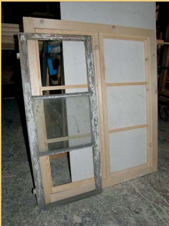
Die Fotos zeigen die Herstellung der Fenster im Laufe des Jahres 2011, eine Holzverbindung, das Profil der Fensterbekleidung, Fensterflügel und Fensterladen, Fenster und Bekleidung vor dem Anstrich und links unten die Gegenüberstellung eines alten und neuen Fensterflügels.
