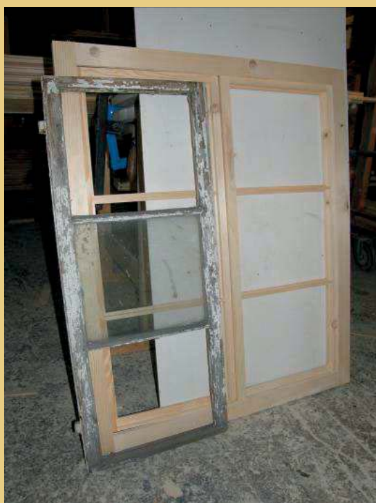
Fotografie z průběhu výroby oken během roku 2011 – ukázky spojů, profilace obložky, křídel a okenic, celek okna s obložkou před nátěry a dole vlevo srovnání původního křídla a nového výrobku.
