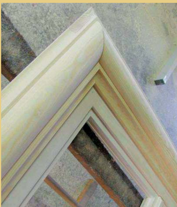
Fotografie z průběhu výroby oken během roku 2011 – ukázky spojů, profilace obložky, křídel a okenic, celek okna s obložkou před nátěry a dole vlevo srovnání původního křídla a nového výrobku.
