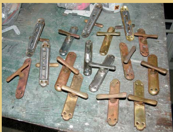
Ukázky doplňků oken, nových zasekávacích bambulkových závěsů s povrchovou úpravou v barvě oken a druhotně použitých rozvor se štítky a kličkami.
